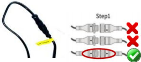
Verbinden Sie anschließend den hinteren Joystick mit der Batterie auf die gleiche Weise. Die Kabel befinden sich hinter der Sitzfläche. Die Kabel sind dafür mit gelben Markierungen versehen. Achten Sie auch hier wieder auf die korrekte Ausrichtung der Stecker.
