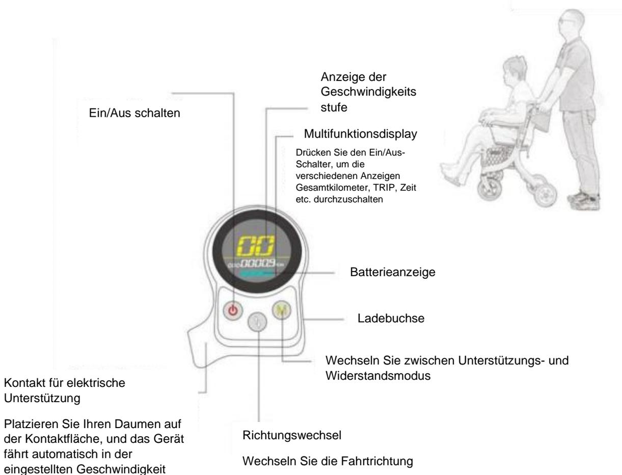
Der hintere Joystick verfügt über zwei verschiedene Modi: Den **Unterstützungs-** sowie den **Widerstandsmodus**. Der Unterstützungsmodus unterstützt Sie beim Vorwärtskommen, während der Widerstandsmodus einen gewissen Fahrwiderstand bietet, der das Gerät bremst. Das ist sehr hilfreich, wenn Sie beispielsweise bergab fahren.
