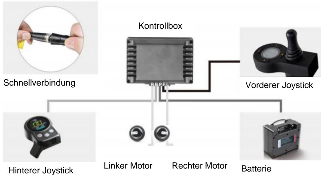
Verbinden Sie alle Kabel wie in diesem Diagramm dargestellt. Achten Sie auf die gelben Markierungen an den Kabeln (siehe Abbildung).
