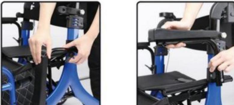
Setzen Sie dann den Joystick auf die Armlehne auf. Entfernen Sie dafür zunächst die Feststellschraube und stellen dann die gewünschte Position des Joysticks ein. Ziehen Sie die Schraube abschließend wieder fest an (siehe Abbildung).
