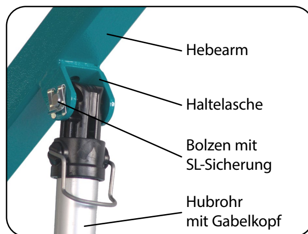
Abb. 6.2.05 – Montage des Hubantriebes
