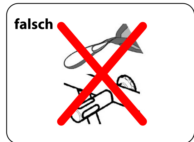
Abb. 6.2.4.09 - Gurtschlaufe falsch eingehangen
